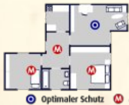
Rauchmelder in einer 3-Zimmer-Wohnung
